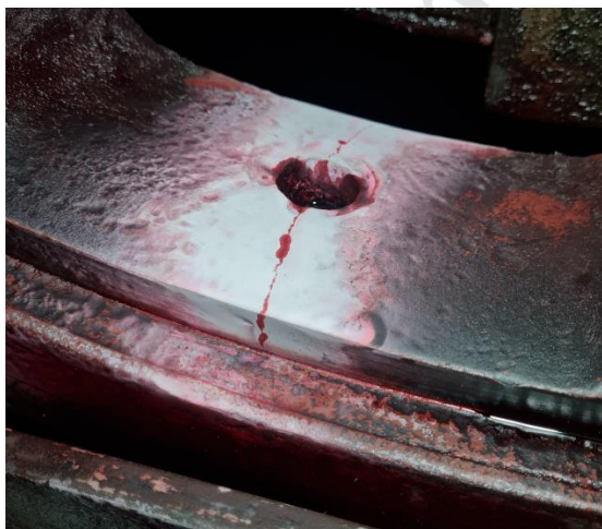
Fig. 3 – Trinca na roda – Teste com Líquido Penetrante.
