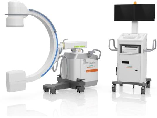
O sistema possui uma alta capacidade de armazenamento térmico do ânodo (101.000 HU) e uma capacidade de resfriamento do ânodo de 55.000 HU/min que permitem cenas fluoroscópicas de longa duração e proteção contra superaquecimento.
